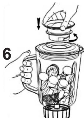
6. Вставьте колпачок в направляющие крышки, поверните против часовой стрелке до упора.
